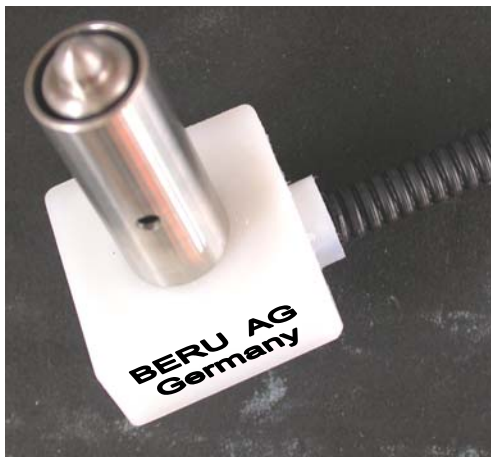
Abbildung 8-8: A-Muster des späteren Kraftstoff-Seriensensors mit Temperaturkompensation
